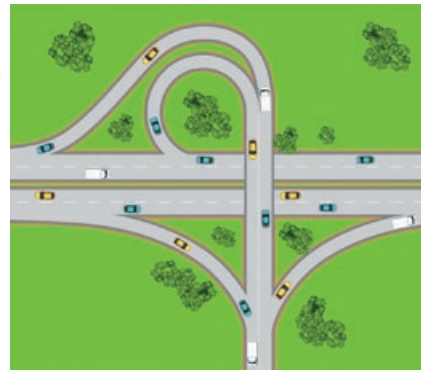
Exemple de carrefour dénivelé avec échanges.
