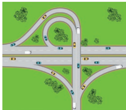
Exemple de carrefour dénivelé avec échanges.
